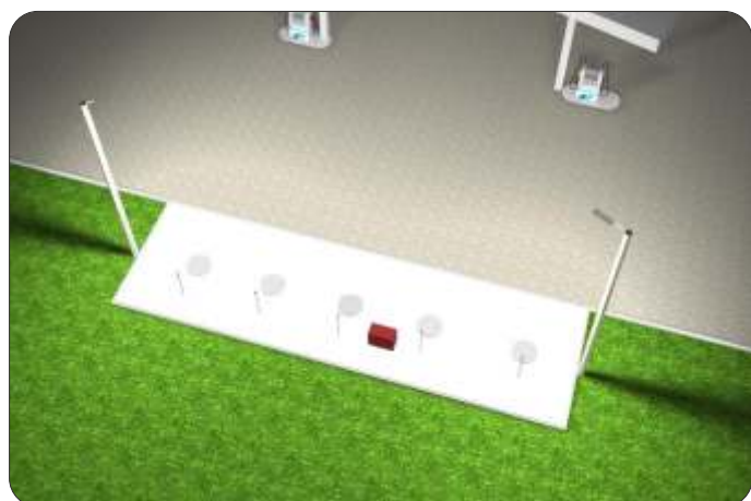
Рисунок 2 - Сравнение освещённости от двух светильников, имеющих различные типы КСС (тип «Д» и тип «Г») Светильник с косинусной КСС (тип «Д»).
